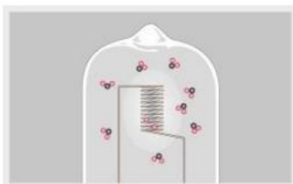
Moléculas halógenas "toman" a las partículas de tungsteno
