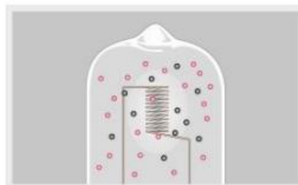
Moléculas halógenas previenen el ennegrecimiento
